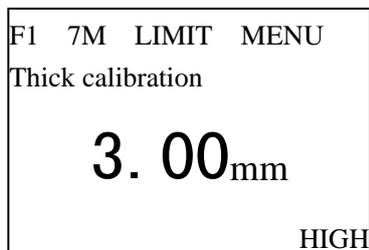
e. 测量厚的标准试块, 用 $\wedge$ 或 $\vee$ 键将测量值调整到标准值, 然后按 **ENTER** 键, 完成校准操作, 即可进行测量状态。
