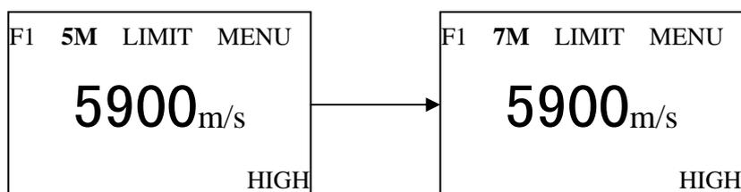
每按一次 ENTER 键将依次显示 ZW、5M、7M、ZW，直到设定的所需要的探头频率。
