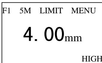
在仪器工作一段时间后，当发现测值有些不准确时，可再次测量标准试块，当测量值存在大于 $\pm 0.04\text{mm}$ 时，按 **ZERO** 可随时进行较零操作。
